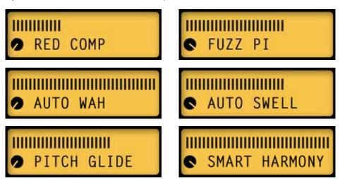
Сверху показаны основные и второстепенные модели FX1 блоков Gain, Auto и Pitch. Регулятор слева в минимальном положении означает - это основная модель; в максимальном - второстепенная. Полоски показывают уровень эффекта.
