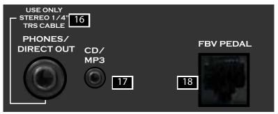
16 Stereo Phones/Direct Output — чтобы слушать звук через наушники, подключите их к этому разъему. Этот стереовыход также служит Директ выходом для подключения Baшего Spider IV к микшерной консоли, PA системам, ПК, устройствам записи или другому оборудованию с линейным входом. На выходе Вы получите высококачественное звучание, идеально сбалансированное для записи.
